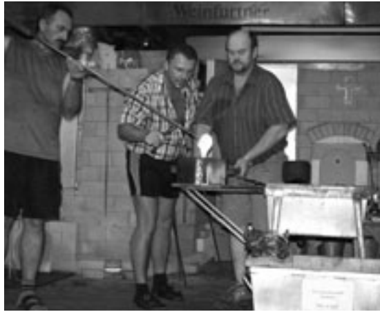
Sepp Obermeier hält die Gießform, in die Mitarbeiter der Glasmanufaktur Weinfurtner die Glasmasse gießen.
